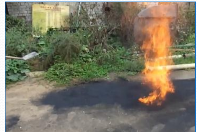
Воспламенение горячего порошкового полукокса
