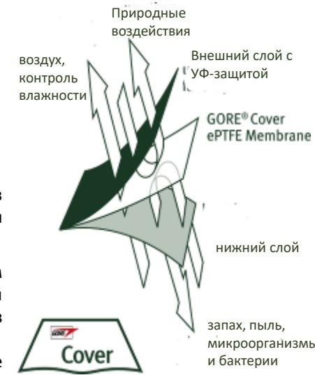
Конструкция ламинированного трехслойного буртового покрытия Gore® Cover состоит из 3 слоев:
